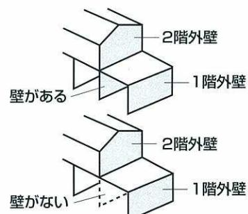
**説明** 2階の壁面と1階の壁面が一致しているれば、2階の地震力はスムーズに1階壁に流れます。2階壁面の直下に1階壁面がなければ、床を介して2階の地震力が1階壁に流れることとなり、床面に大きな負荷がかかります。大地震時には床から壊れる恐れがあります。枠組壁工法の木造(ツーバイフォー工法)は床の耐力が大きいため、2階壁面の直下に1階壁面がなくとも、評点1とします。
