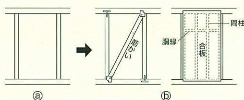
**土台・柱・筋かいなどの接合は金物等を使って堅固にします。**
